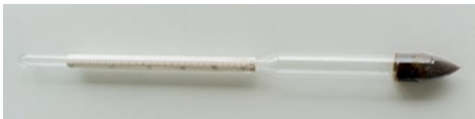
Obrázok 59 Hustomer na určovanie hustoty kvapalín
