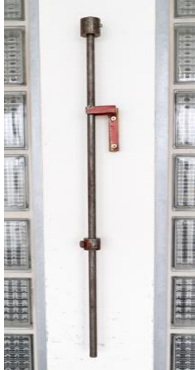
Obrázok 53 Reverzné kyvadlo používané na meranie tiažového zrýchlenia
