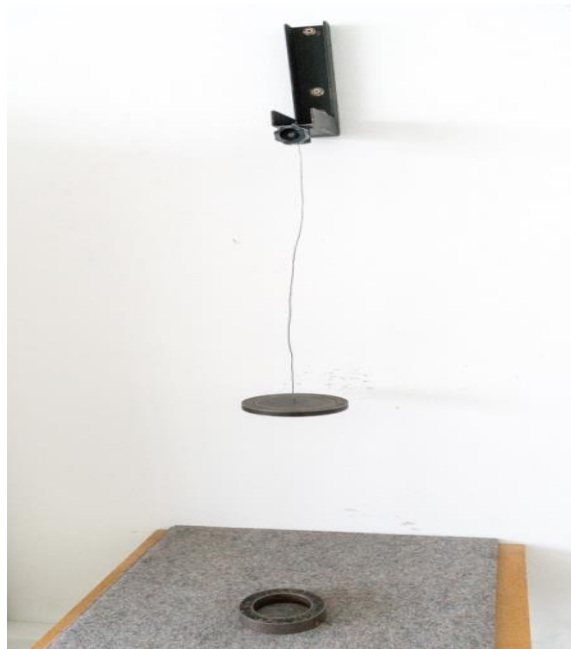
Obrázok 49 Zariadenie pre meranie momentu zotrvačnosti kruhovej dosky
